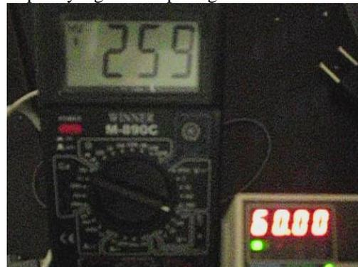
Gambar 4.2 Tegangan Output Inverter untuk Frek.60Hz
