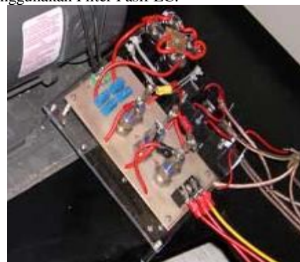
Gambar 4.6 Full Converter Tiga Fasa dengan filter pasif LC secara paralel
