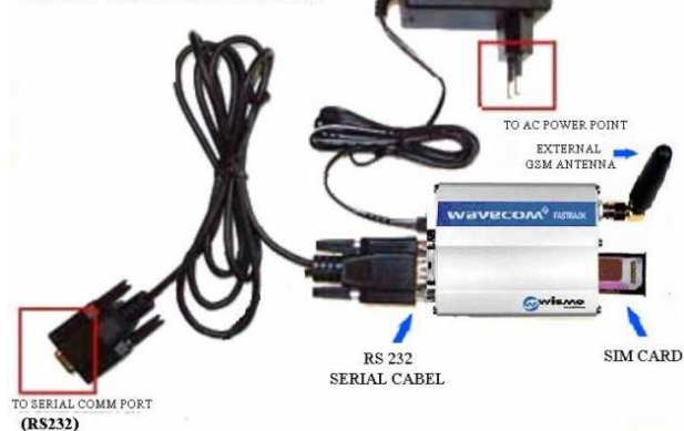
Gambar 3. Konfigurasi Modem dengan kabel serial dan antenna SMA
