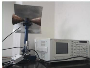
**Gambar 8.** Pengukuran dan Pengujian Antena *Biconical*
