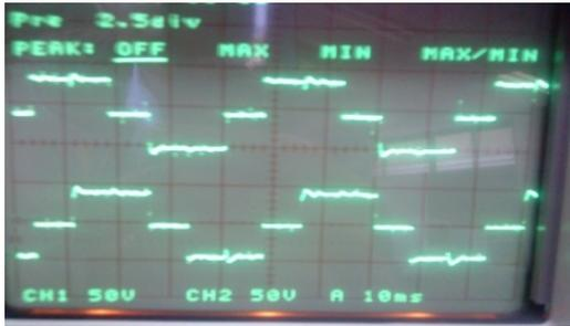
Gambar 2 Sinyal Output Inverter VA dan VC
