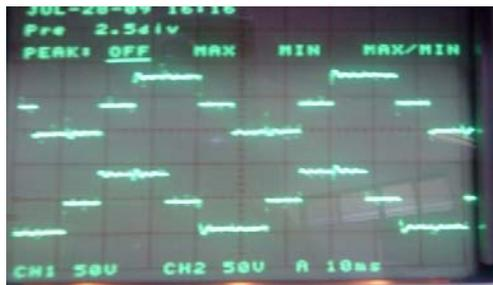
Gambar 3 Sinyal Output Inverter VA dan VB
