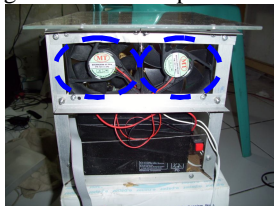
Gambar 8 Tempat pemasangan kipas blower
