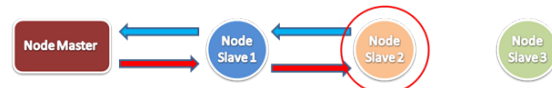
Gambar 9 Posisi node master dan node slave dengan node slave 2 sebagai node destination
