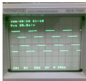
Gambar 5.2 Gelombang PWM phase R-S frekuensi 20 Hz
