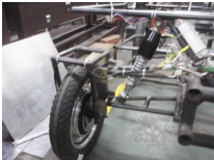
Gambar 2.2 Bagian roda belakang KLBS G-1 yang sudah terpasang dengan suspensi
