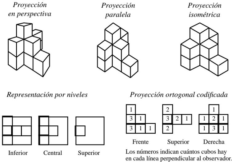
Figura N° 1. Representaciones planas de un módulo multicubo
