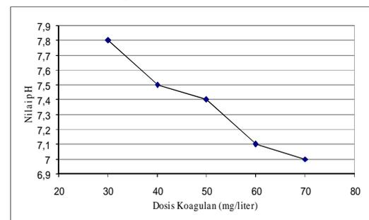
Gambar 3. Hubungan dosis optimum koagulan terhadap pH
