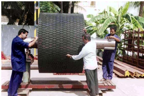
Gambar 2.16. Penservisan Motor dan Pulley.
