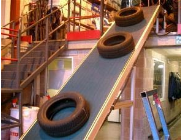
Gambar 2.23. Bentuk Karet belt conveyor.
