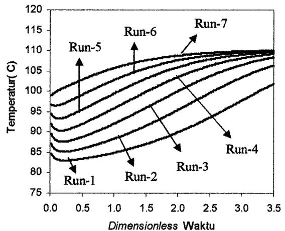
Gambar 11. Profil temperatur benzene-toluene untuk Run-1 sampai Run-7.
