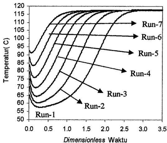
**Gambar 2.** Profil temperatur aseton-n-butanol untuk Run-1 sampai Run-7
