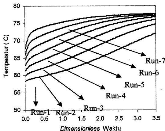
Gambar 5. Profil temperatur aseton-etanol Run-1 sampai Run-7
