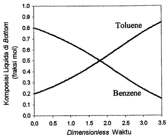
Gambar 13. Profil komposisi liquida di *bottom* benzene-toluene Run-1
