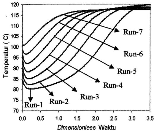
Gambar 8. Profil temperatur etanol-n-butanol untuk Run-1 sampai Run-7
