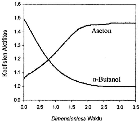
**Gambar 3.** Profil koefisien aktifitas aseton-n-butanol Run-1
