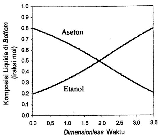
Gambar 7. Profil komposisi liquida di *bottom* aseton-etanol Run-1
