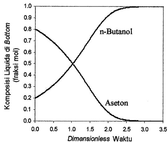
**Gambar 4.** Profil komposisi liquida di *bottom* aseton-n-butanol Run-1
