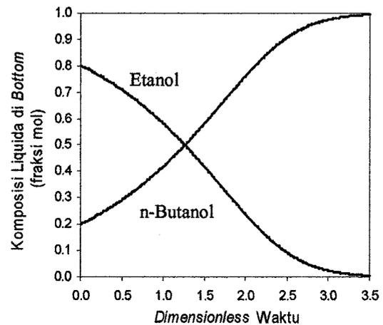
Gambar 10. Profil komposisi liquida di *bottom* etanol-n-butanol Run-1
