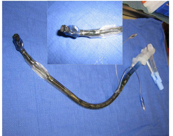
Şekil 12. Oksijenin koter ile tutuşarak endotrakeal tüpü yakması sonucu gelişen hasar.
