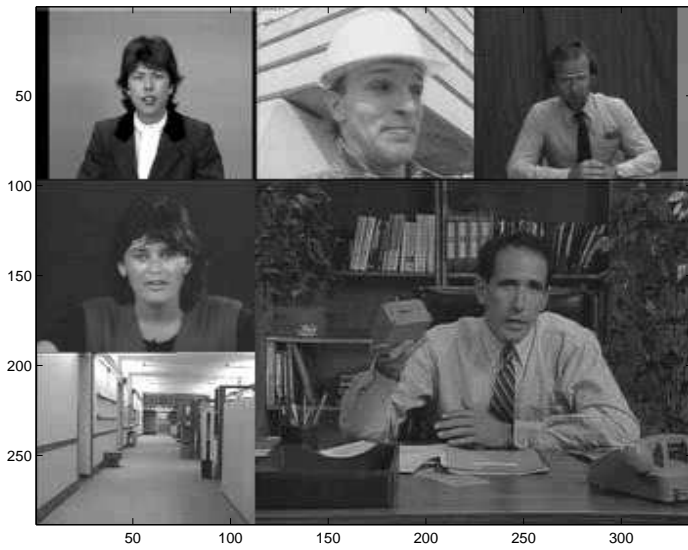
(d) Conventional DCT (QP=5), 64231 bits PSNR=35.9628 dB
