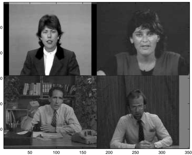
(e) DCT-EZT, 51480 bits PSNR=39.2019 dB
