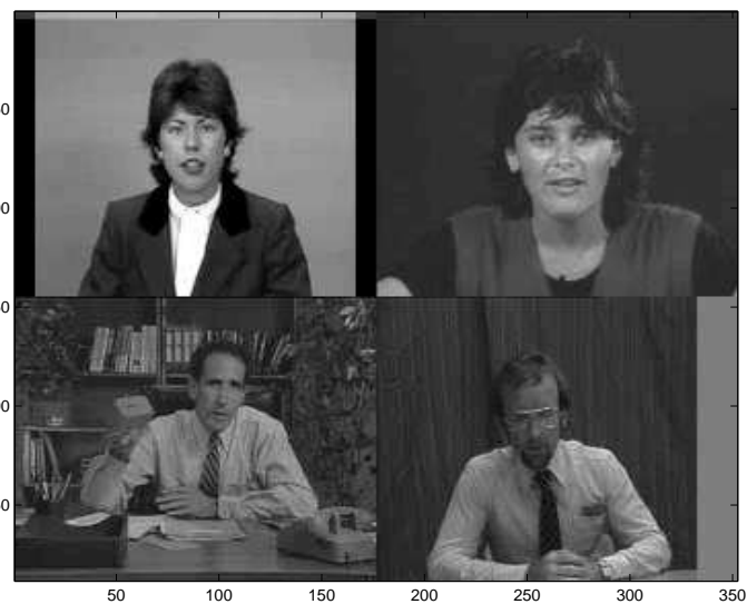
(g) DCT-EZT, 30042 bits PSNR=36.3004 dB
