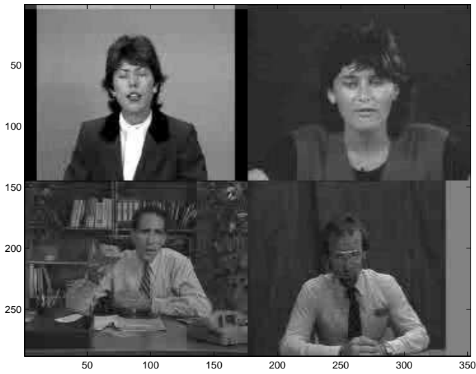
(d) DCT-EZT, 10000 bits PSNR=31.9405 dB
