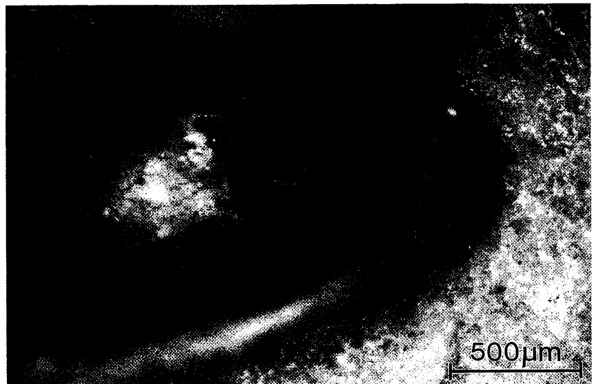
Abb. 12: Laser-Stapedotomie mit dem Er:YSGG-Laser ( 2,78\ \mu\text{m} ). Betrieb: gepulst; Energiedichte: 5 Pulse a 55,8\ \text{J}/\text{cm}^2 ; Rep.Rate: 1 Hz. Durchmesser: Perforation = 500\ \mu\text{m} ; Karbonisationszone = 540\ \mu\text{m} ; keine Kristallisationszone; thermische Übergangszone = 620\ \mu\text{m}
