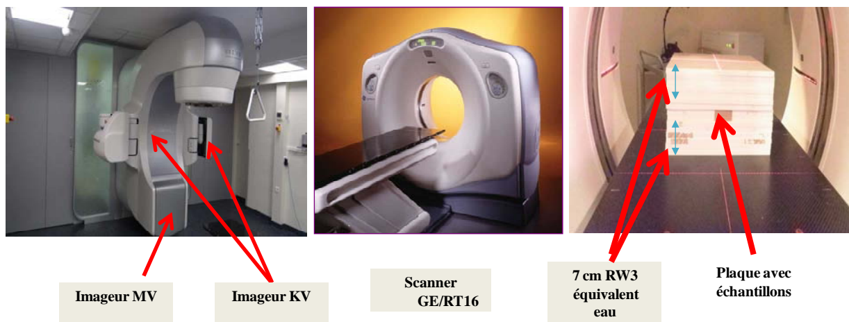
Figure 2 : Images des différents types d'imageur utilisés et du fantôme.
