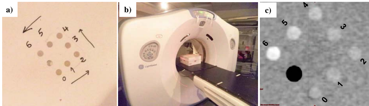
Figure V.17. (a) Plaque en plastique contenant des suspensions de NPs de Gd_2O_2S:Eu^{3+} dans du gel d'agar (1,5%.mass); (b) image de la plaque dans le scanner (c) Image en tomographie par rayons X acquise à l'aide d'un appareil de radiographie: 0 : control, 1 : 0,52 mM, 2 : 1,04 mM, 3 : 2,08 mM ; 4 : 4,16 mM, 5 : 8,32 mM , 6 : 16,64 mM.
