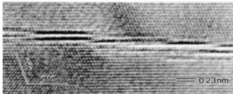
Figure I-23 : Précipité  $T_1$  cisailé à plusieurs reprises dans Al-2,86Cu-2,05Li-0,12Zr (Nie & Muddle 2001).
