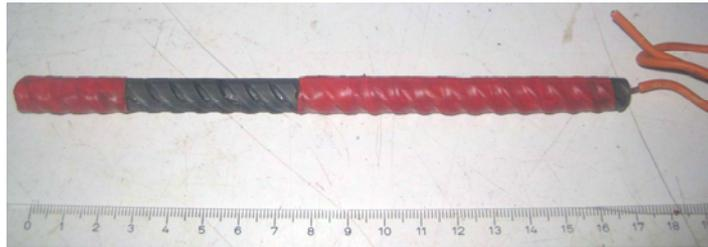
**Figure 38. Barre d'armature utilisée pour les mesures d'électrochimie sur éprouvettes de béton ou de mortier armé**
