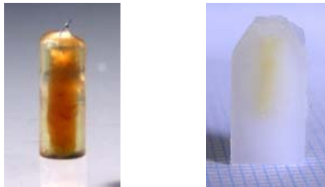
FIG. 3.5 – Échantillons inclus : (gauche) dans une résine époxy, (droite) dans du polyéthylène glycol (PEG).
