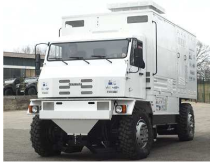
Figure I. 3 : Véhicule hybride lourd de la plateforme expérimentale ECCE 37 utilisée par la DGA.
