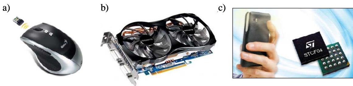
Figure I. 5 : Diverses applications des supercondensateurs : souris sans fil équipée de supercondensateur pour une recharge instantanée (Genius DX-Eco) (a), 43 carte graphique équipée de supercondensateur de type NEC Proadlizer (b), 44 cellule utilisant les supercondensateurs pour améliorer les flashes de téléphone portable (c). 45
