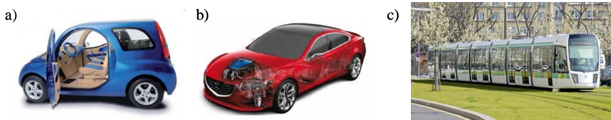
Figure I. 4 : Application des supercondensateurs dans le domaine du transport. Voiture électrique « Blue Car » de Bolloré utilisée pour le service Autolib (a), 38 Mazda i-ELOOP utilisant les supercondensateurs pour la récupération de l'énergie au freinage (b), 7 Tramway Alstom Citadis en service sur la ligne T3 du tramway parisien (c). 39
