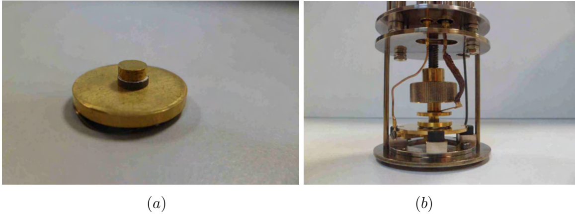
FIGURE 3.28: (a) L'échantillon métallisé et placé entre deux pastilles de 2\text{ cm} et 5\text{ mm} de diamètre, le tout est déposé sur un ressort de 2\text{ cm} . (b) Cellule de mesure avec l'ensemble échantillon-pastilles.
