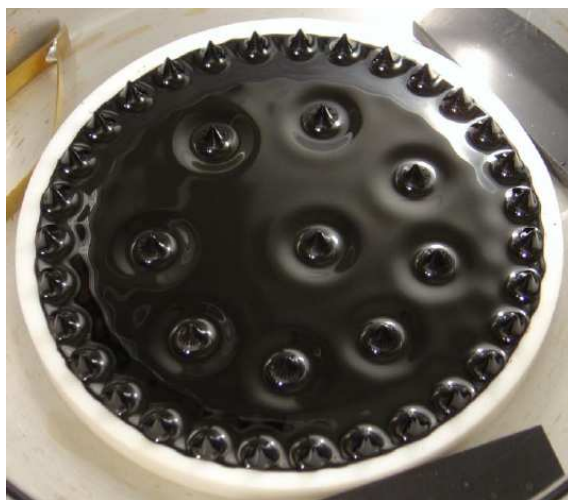
FIGURE 2.25 – Photographie d'une solution constituée de 9 solitons pour une induction magnétique uniforme de 8.91mT. D'après [31].
