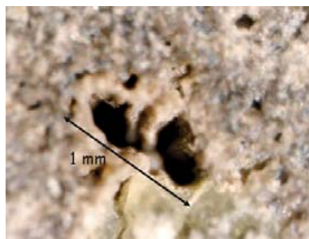
FIGURE 6.4 – Exemple de cratère réalisé sur un basalte avec l'EQM. Celui-ci est réalisé suite à 3000 tirs.
