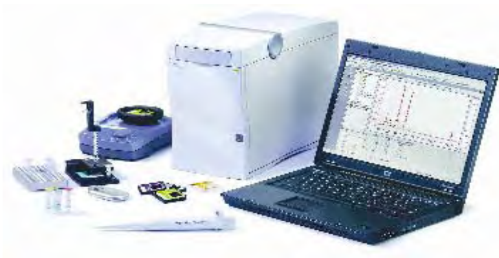
Figure 46 : Instruments de « l'Agilent 2100 bioanalyzer ». Cette technologie est utilisée pour vérifier la qualité des ARN extraits à partir des échantillons cornéens. Cette vérification est effectuée sur des puces RNA Pico Chip (Agilent Technologies, Waldbronn, Germany) à cause de la faible quantité d'ARN récupérée à partir des échantillons cornéens.
