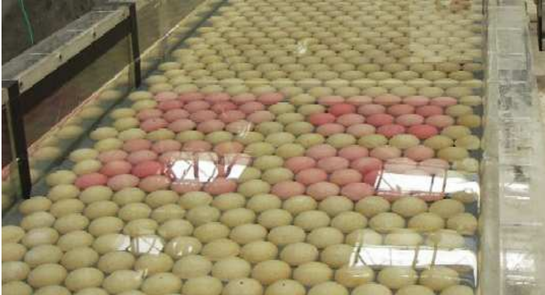
Figure II. 11. Plaques de prélèvements (hémisphères en rose) pour le test d'arrachage [Pen, 2008].
