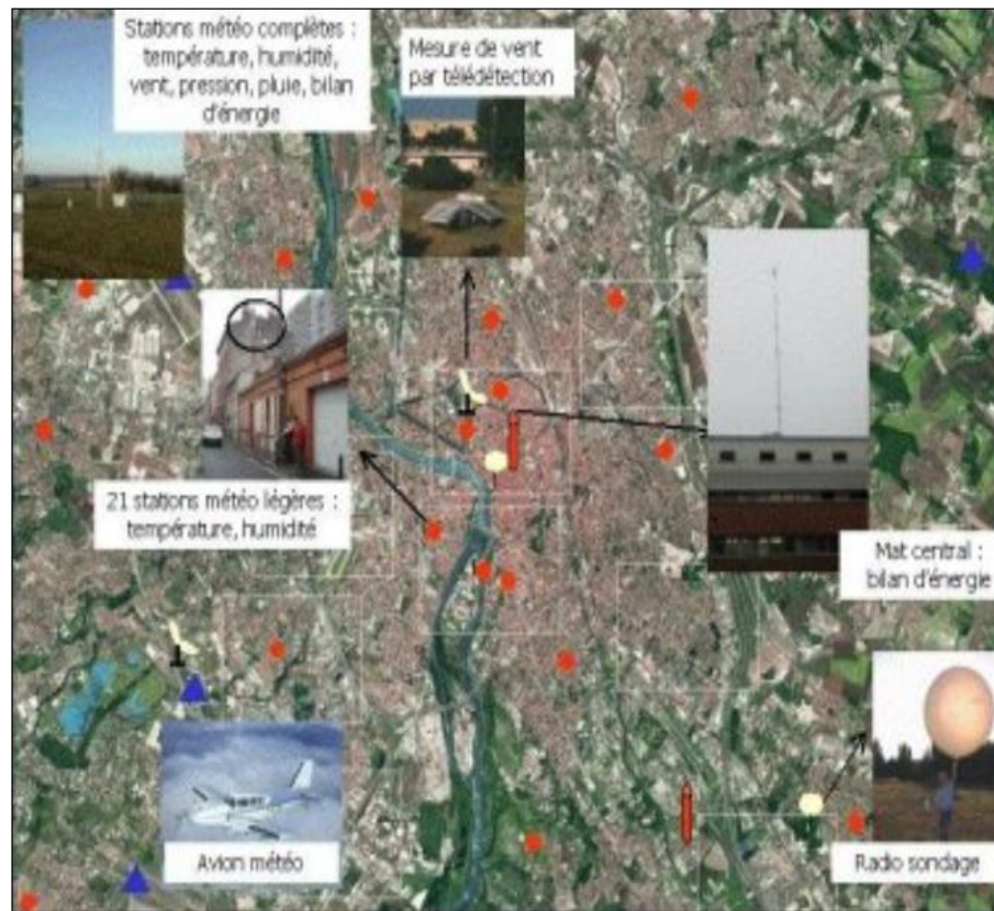
Fig. 5.1: Représentation de l'ensemble du dispositif expérimental dédié aux mesures dynamiques durant la campagne CAPITOU.
