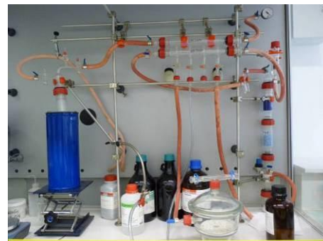
Figure 2.7 – Rampe à vide employée pour la fonctionnalisation de surface.
