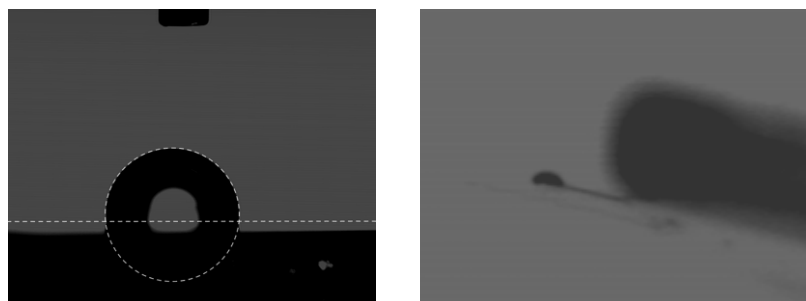
Figure 2.8 – A gauche, image d'une goutte d'eau déposée sur une surface traitée au 1H,1H,2H,2H-perfluorodécyltrichlorosilane observée au goniomètre pour évaluer son angle de contact. A droite, image de microscopie optique d'une goutte de glycérol déposée sur le levier d'une pointe NADIS hydrophobe.
