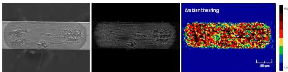
Figure 36 : Photographie, cartographie et cartographie retraitée du dépôt en supprimant le chauffage. Sur la cartographie retraitée, les zones noires et marron représentent les plus fortes concentrations en néodyme, les bleues les zones où le néodyme est absent ou très peu présent.
