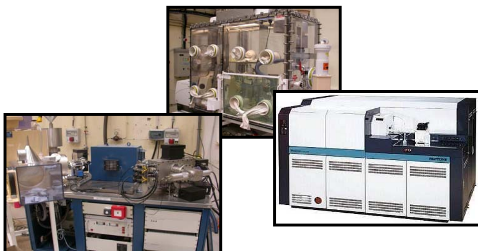
De gauche à droite : un TIMS, un Q-ICPMS, un MC-ICPMS
