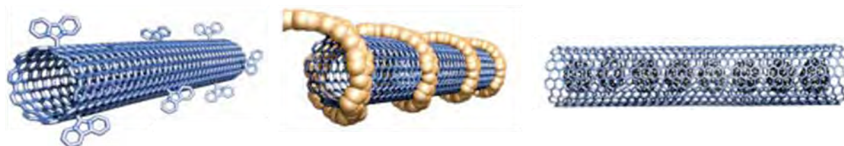
Figure 16 : De gauche à droite, illustrations représentant une fonctionnalisation covalente, non covalente et un nanotube rempli. 163
