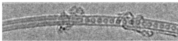
Figure 7 : Formation de la paroi interne d'un DWNT par coalescence d'endofullerènes (visible dans le SWNT sur la droite de l'image) 66 .
