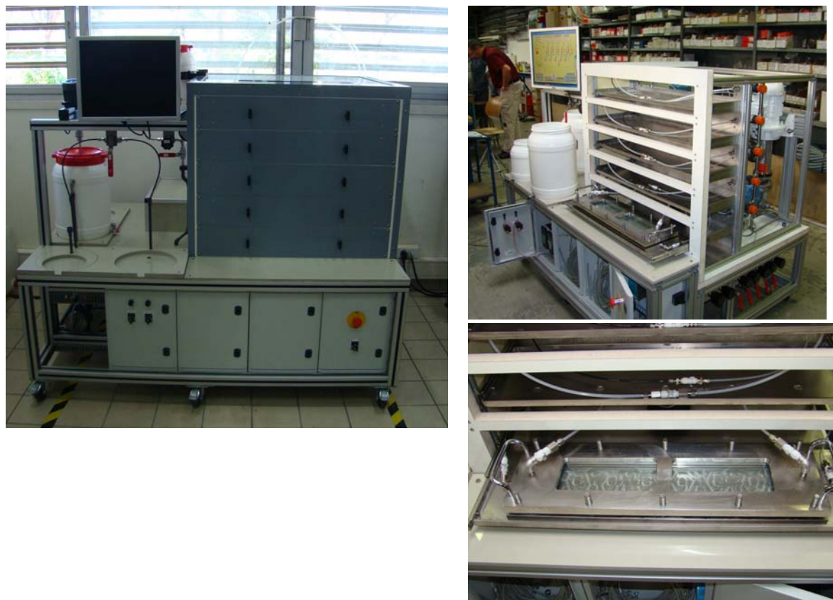
Figure II-2 : Photographie du pilote utilisé pour le développement des biofilms aérés sur membrane. En haut à gauche : le pilote en entier avec les tiroirs fermés. En haut à droite : le pilote ouvert. En bas à droite : une unité de contacteur membranaire du pilote
