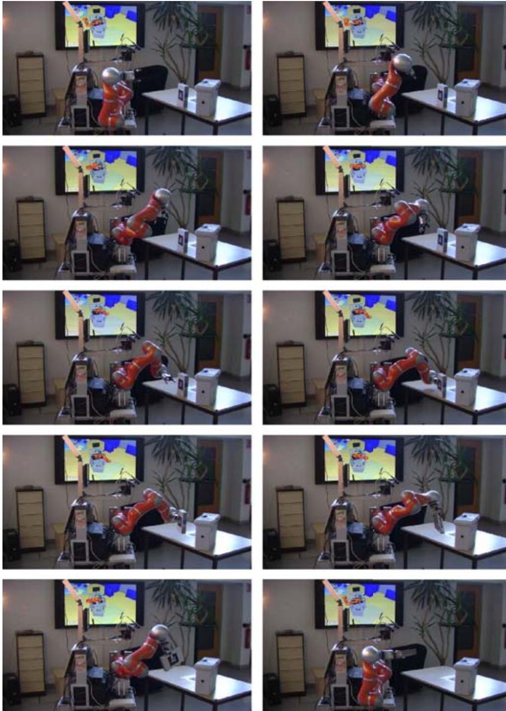
FIGURE 6.9 – Séquence de mouvement illustrant la tâche de saisie de la cassette grise en présence d'un obstacle
