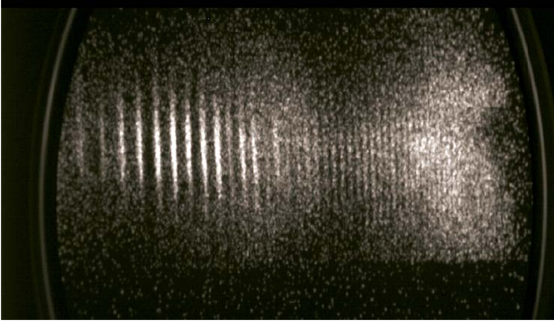
FIGURE 5.10: Spectre harmonique généré dans l'argon à 1830 nm.
