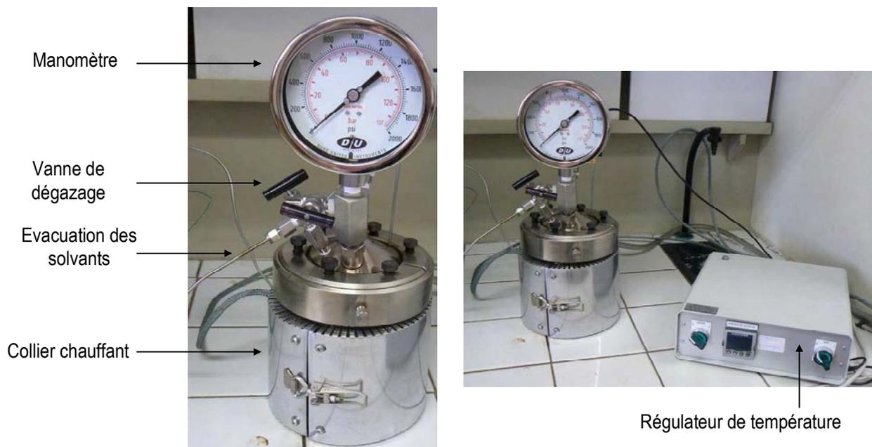
Figure II-3 : Dispositif utilisé avec l'autoclave de type 4621 de 1 litre.
