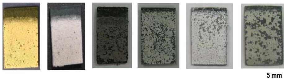
Figure V-1 : De gauche à droite : Revêtements TA950 (336 cycles), A500 (511 cycles), A950 (770 cycles), TA700 (770 cycles), T (970 cycles) et A700 (1053 cycles) sur le système NiCrAlY/HX après cyclage thermique.
