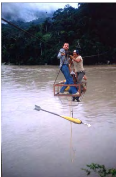
Figure 2-3. Jaugeage des grands fleuves au moulinet sur câble et sur bateau (clichés : Jean-Loup Guyot)
