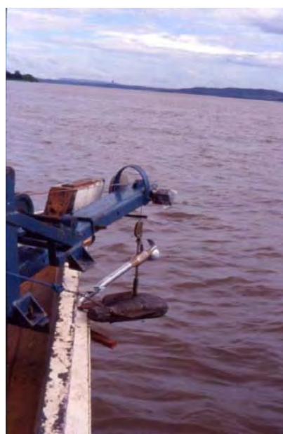
Figure 2-3. Jaugeage des grands fleuves au moulinet sur câble et sur bateau (clichés : Jean-Loup Guyot)
