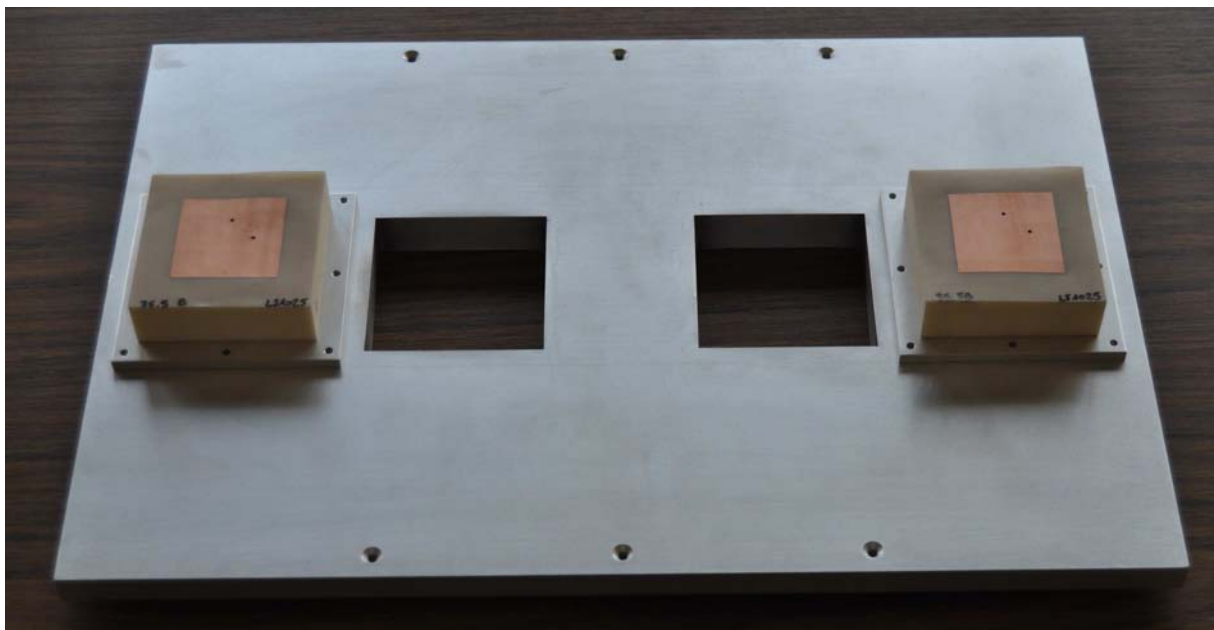
(b) Plan de masse de l'antenne réseau à deux éléments de référence avec les patches à insérer
