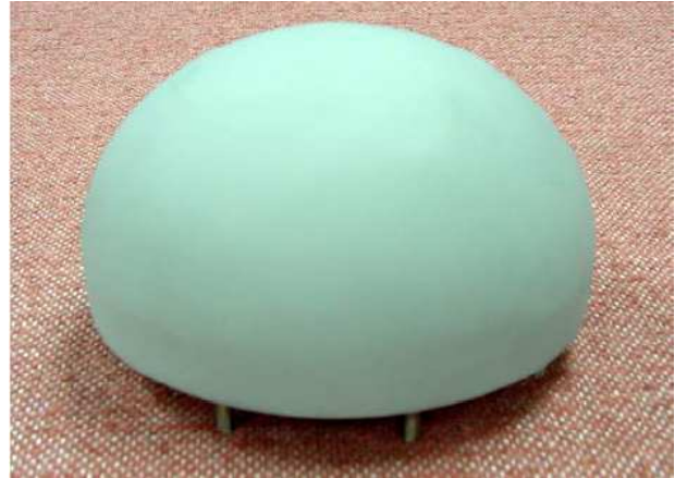
Figure 35 : Schéma et photographie de l'antenne S-CRPA L1/L2 [17]
