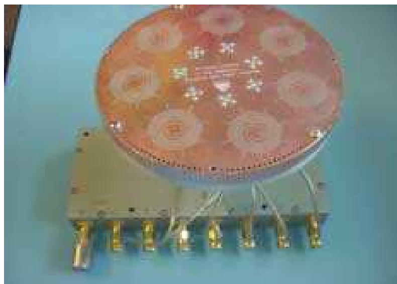
Figure 36 : Advanced Pinwheel Compact Controlled Reception Pattern Antenna (AP-CRPA) avec système de traitement adaptatif [21]
