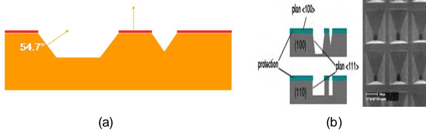
Figure II. 3 : Différents profils de gravure humide anisotrope en silicium cristallin pour application unique; (b) des exemples de micropuits faits par gravure humide anisotrope [72].
