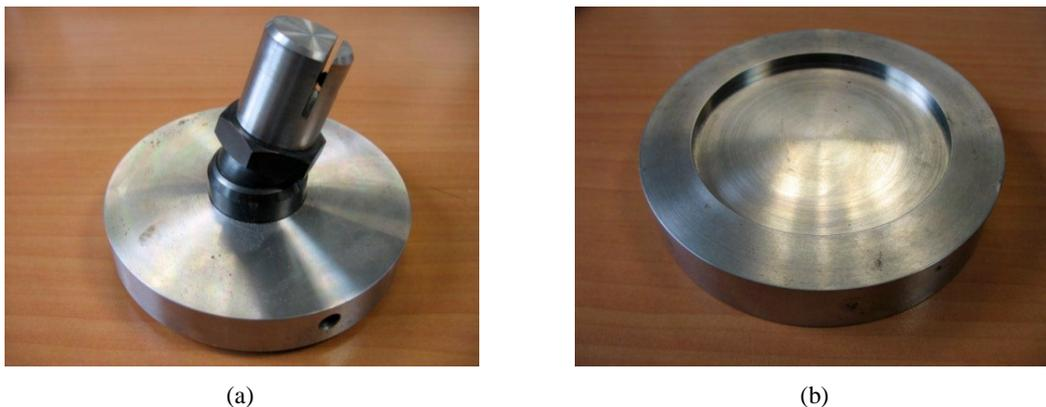
**Figure 3.5 :** dispositif de pressage : (a) rotule montée sur la mâchoire supérieure, (b) mâchoire inférieure instrumentée de la presse.
