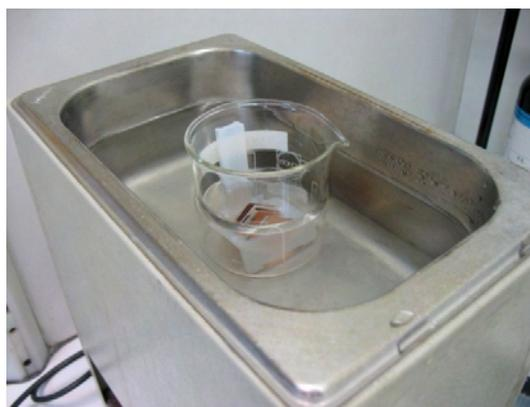
**Figure A. 5 :** Nettoyage au bain à l'ultrason
