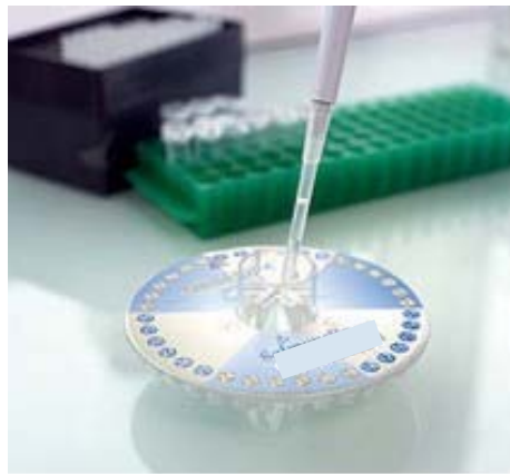
Figure III-4. GeneDisc et puits réactionnels. Un secteur de 6 puits représente les analyses réalisées pour un échantillon (2 témoins positifs, 1 témoin négatif, 3 quantifications d'échantillon).
