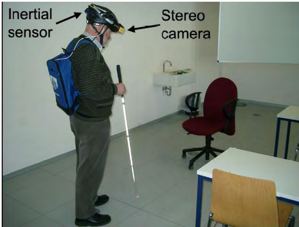
Figure 19: Illustration du dispositif d'aide à la navigation en intérieur développé à Stuttgart (Hub et al., 2007). Le sujet porte un casque sur lequel est disposé un capteur de vision stéréoscopique et un capteur inertiel (Xsens MT9B ; 3 axes). Un petit ordinateur porté dans le dos du sujet effectue les calculs.
