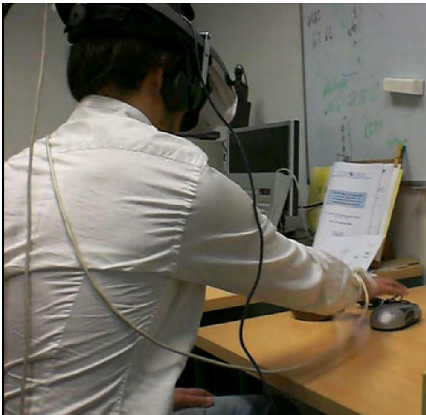
Figure 125: Un sujet voyant équipé du modèle de neuroprothèse va saisir une souris sur la table sur la base de phosphènes affichés dans le casque de réalité virtuelle. La position de l'objet reconnu est envoyée au modèle par l'outil de reconnaissance et de localisation d'objets développé dans ce manuscrit.
