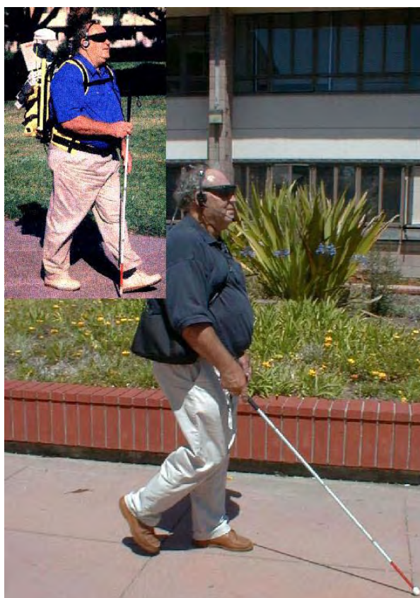
Figure 24 : Personal Guidance System développé à Santa Barbara par Jack Loomis. Le système dont le schéma matériel est décrit dans la figure précédente présente les différents modules composant le système : des capteurs inertiels, un GPS, une interaction vocale en entrée et une synthèse sonore pour la restitution des informations.
