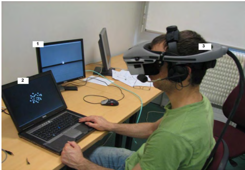
Figure 118: 1- Écran de contrôle de la scène virtuelle pour l'expérimentateur. 2- Écran de contrôle du rendu du modèle pour l'expérimentateur. 3- Casque de réalité virtuelle porté par le sujet.
