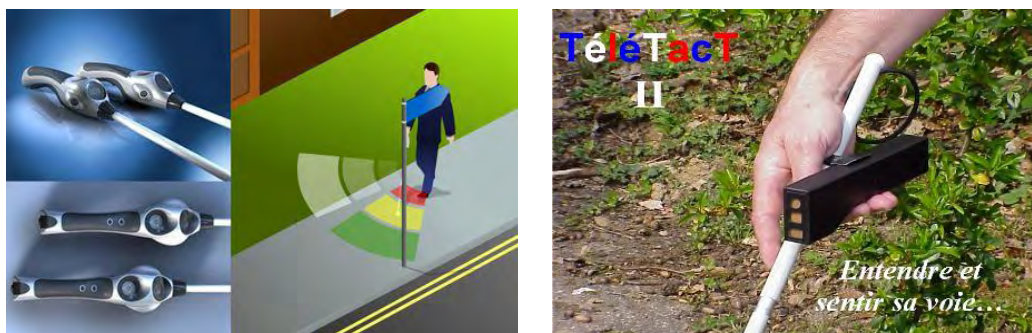
Figure 18 : Illustrations des cannes à ultra sons de sound foresight (à gauche) et canne laser Télétact (à droite). La restitution est tactile pour les deux dispositifs.
