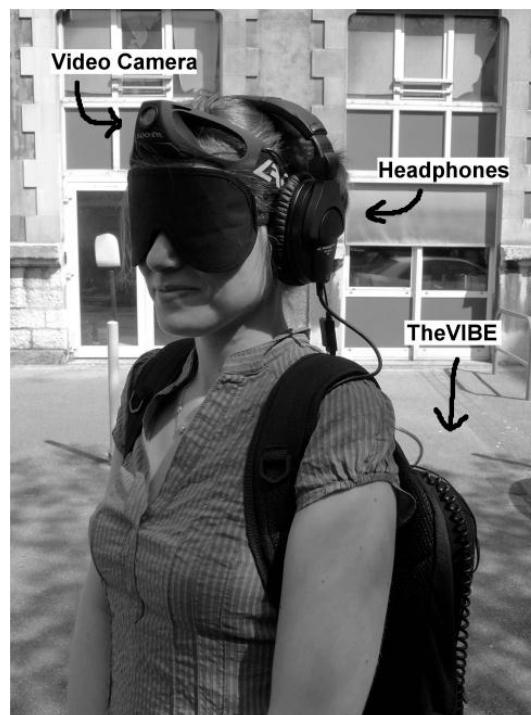
Figure 14 : illustration du système 'The Vibe' : une caméra grand angle est disposée sur le front du sujet. L'image est envoyée au système qui la restitue sous forme de sons dans un casque audio.
