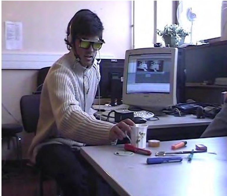
Figure 71 : Première version du dispositif de vision : deux caméras miniatures analogiques sont disposées sur une monture de paire de lunettes. Le sujet est de plus équipé d'un micro et d'un casque audio.
