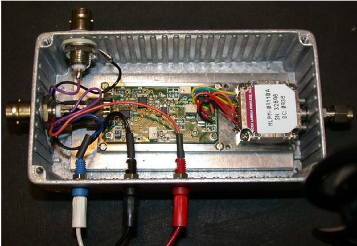
Figure 6. 6 Oscillateur YIG (Micro-lambda) 9-11 GHz et son circuit de contrôle magnétique
