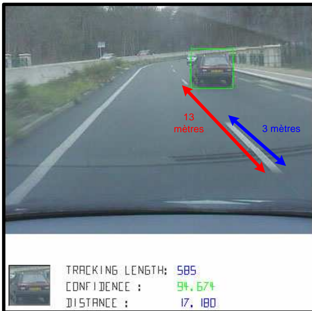
Figure 93 : Principe de comparaison de la mesure de distance [Wybo 00]
