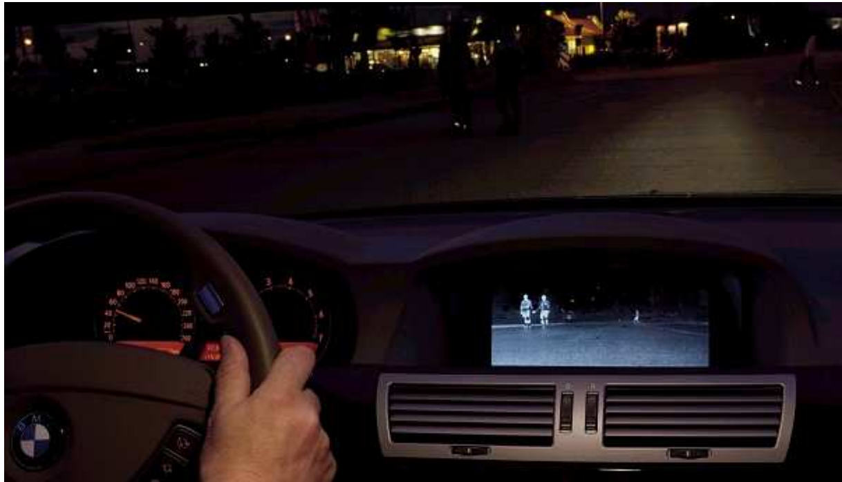
Figure 40 : exemple d'implémentation d'une aide à la conduite de nuit par caméra thermique
