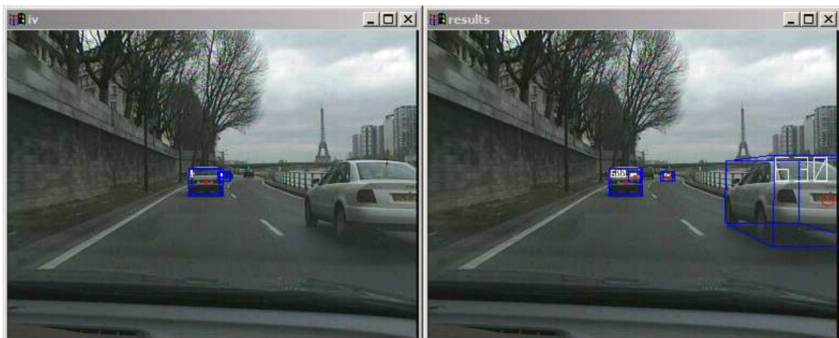
Figure 95 : Comparaison de la détection d'obstacles par radar seul (à gauche) et après fusion (à droite) [Steux 01]
