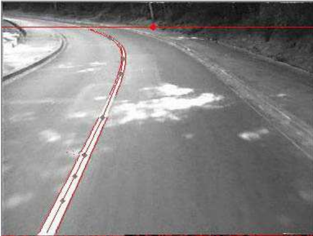
Figure 43 : Exemple de détection de marquage au sol à partir d'une image vidéo
