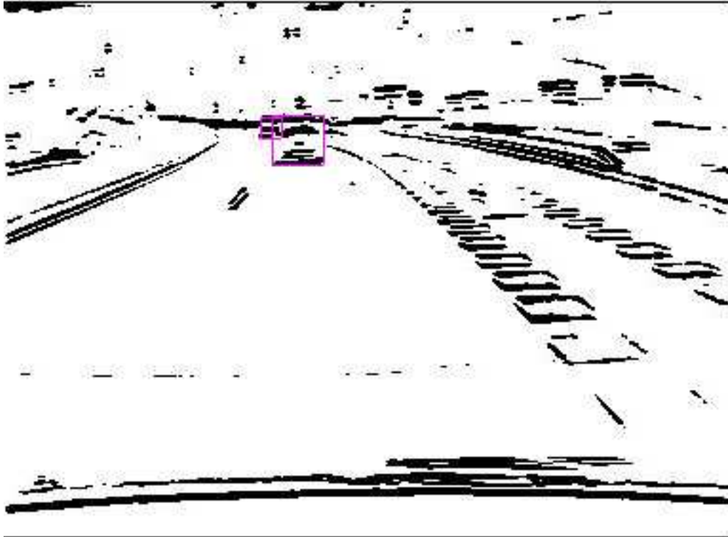
Figure 85 : Extraction des lignes horizontales lors du suivi par extraction combinée des lignes horizontales et verticales [Wybo 00]
