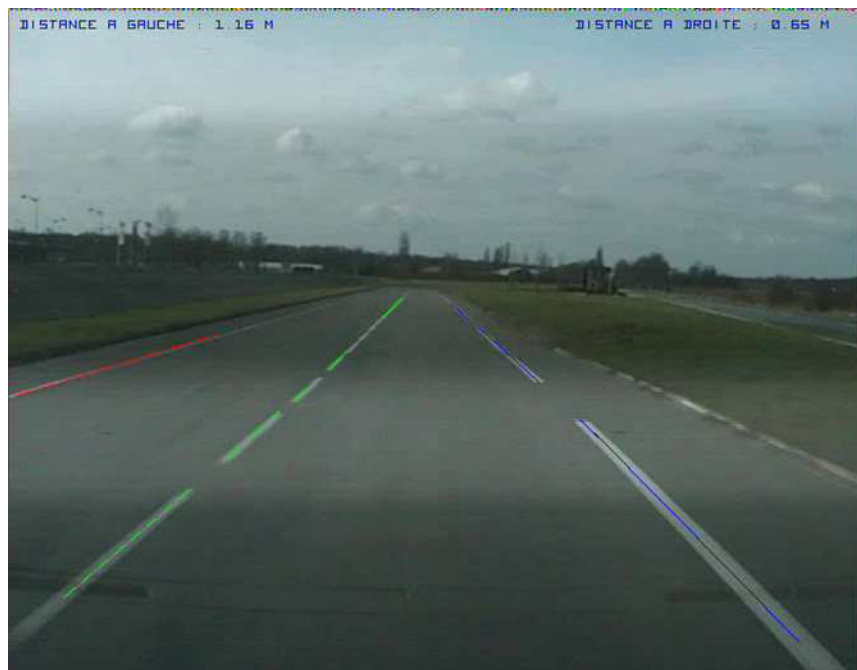
Figure 179 : Détermination des marges de distance latérale grâce à la détection de la route
