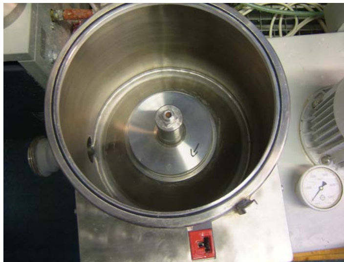
Figure 1-4 : Broyeur utilisé pour les organosilicates.
