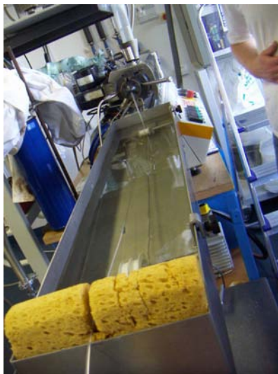
Figure 1-7 : Etape de refroidissement du cordon extrudé
