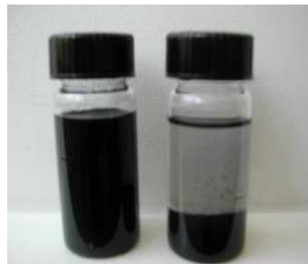
Figure I-7 : Etude de la dispersion de nanotubes de carbone dans une solution polymère. A gauche, les nanotubes ont été traités par plasma (la dispersion est bonne). A droite, les nanotubes n'ont pas subi de traitement (la solution n'est pas stable et il y a sédimentation) (He, 2003).
