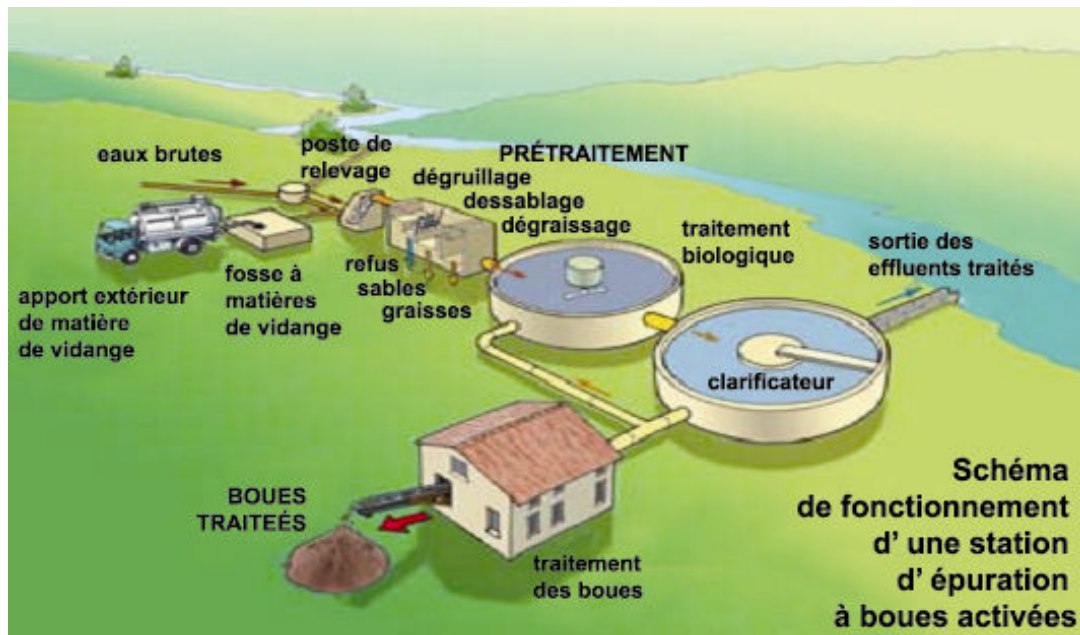
Figure 3.2 : Cycle de l'eau dans une station d'épuration
