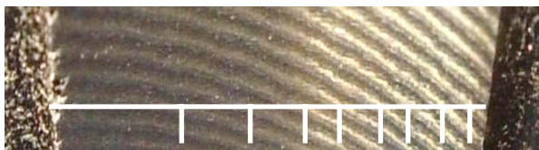
Figure 4. Décompte des stries sur la pièce
