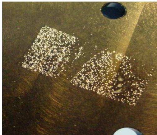
Figure 5 : Anomalie révélée par le retrait d'un ruban adhésif
