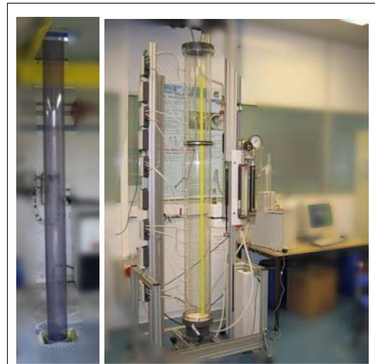
**Figure 41: Veines d'essais du LGC pour l'étude des écoulements gaz-particules dense verticaux descendant (gauche) et des mécanismes de défluidisation (droite). Tavares<sup>44</sup>.**
