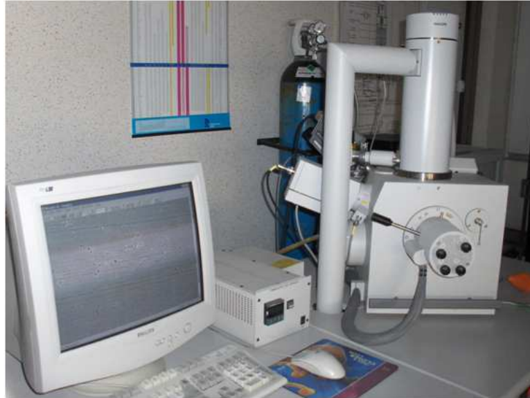
Figure A1.1: Microscope électronique à balayage Philips-XL 30 utilisé pour les analyses surfaciques et fractographie
