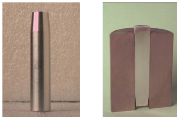
FIG. 2.11 – Essai d'extrusion conique
